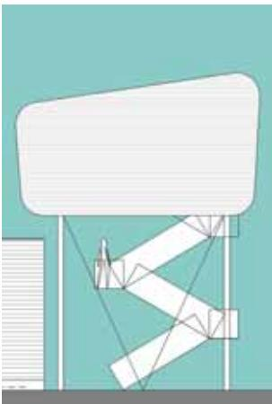
Auf einem maßgeschneiderten Grundstück mit einer bestehenden Postzustellbasis sollte bei dem ungestörten Betrieb der Postlieferungen ein Baukörper mit mehreren Büroeinheiten entstehen. Die Idee, die notwendige, aber im Grundriss fehlende Fläche in den Lüften zu kreieren, fiel wie von selbst. Es wurde eine luftig – leichte Lösung entwickelt die sich von dem regen Postbetrieb erhebt und über dem Bestand schwebt.
